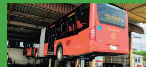
岐阜バスでは全営業所にメンテナンス工場を併設。毎日の点検と定期的な車検を徹底して行い、車体の安全性を保っています。中には全長18mの「清流ライナー」を丸ごと持ち上げられるリフトを備える工場もあり、マニアの間で話題に。
